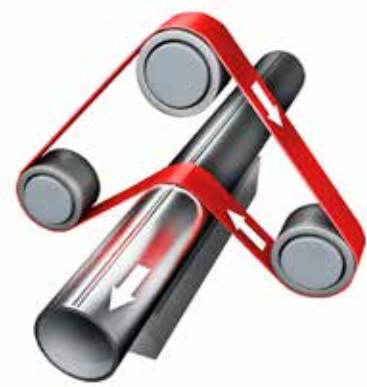
Lijado de cordones de soldadura longitudinal en tubo fabricado por soldadura.
