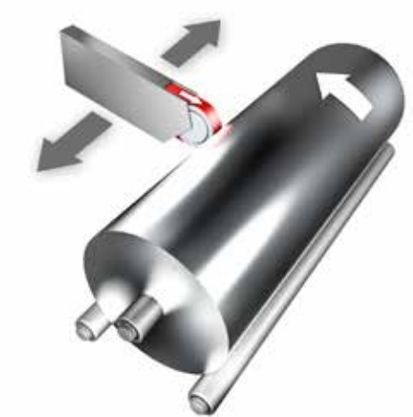
Esmerilado de rodillos en continuo p.ej. entre centros
