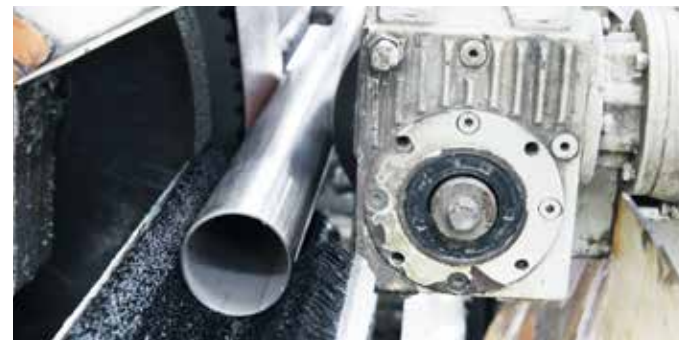
Lijado "Centerless" de tubos y barras.
