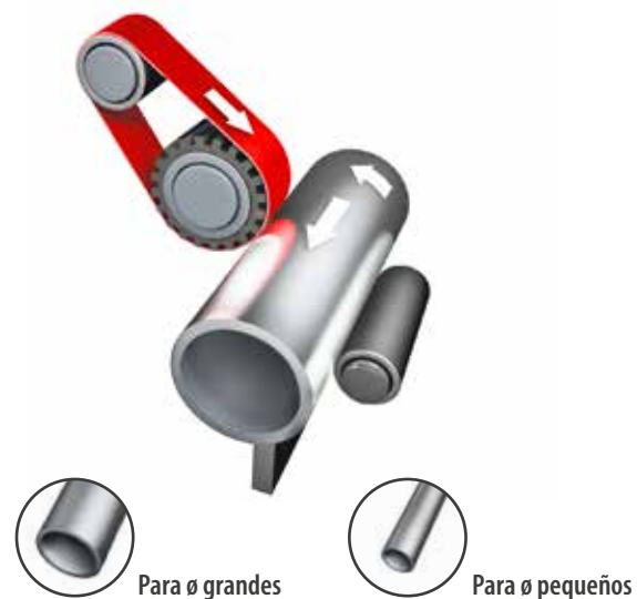
Lijado "Centerless" de tubos y barras.
