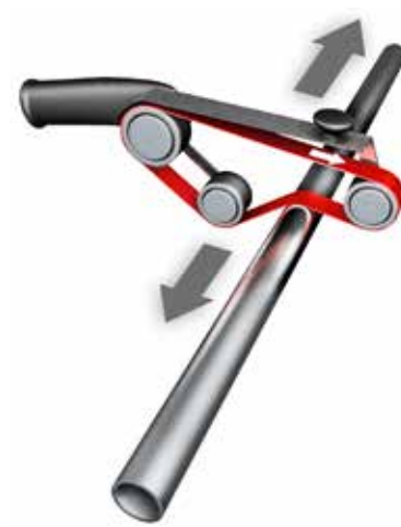
Esmerilado redondo de tubos y barras con lijadora de control manual
