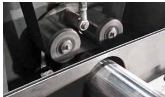
Lijado de cordones de soldadura longitudinal en tubo fabricado por soldadura.
