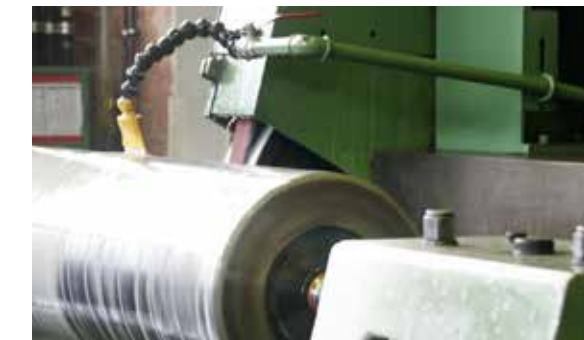
Lijado redondo de émbolos y cilindros p.ej. entre centros
