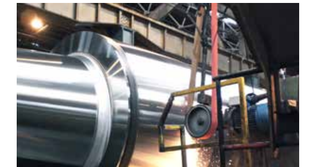
Esmerilado de rodillos en continuo p.ej. entre centros
