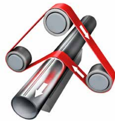
Lijado de cordones de soldadura longitudinales en tubo fabricado por soldadura.
