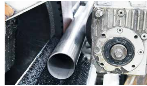
Lijado "Centerless" de tubos y barras.
